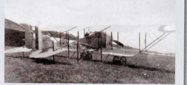
Il Caudron G3 era caratterizzato dalla coda bitrave e dalla piccola navicella per il pilota
